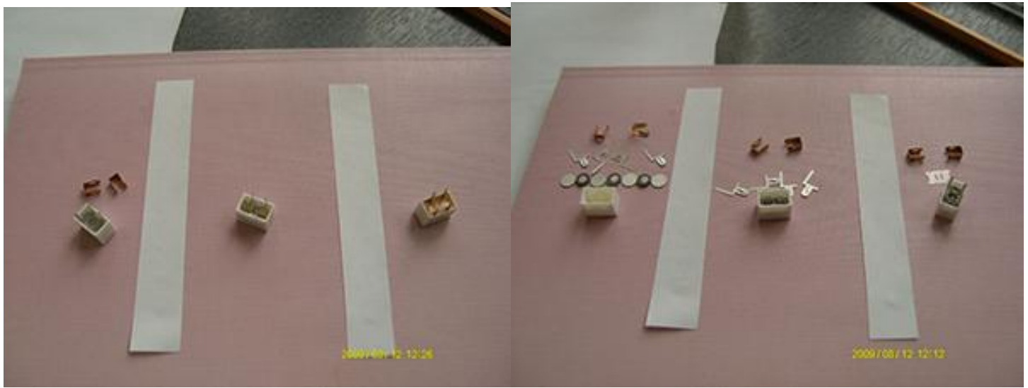
Рис.8. Устройство и последовательность сборки пьезокерамического фильтра ФП1П1-60.
