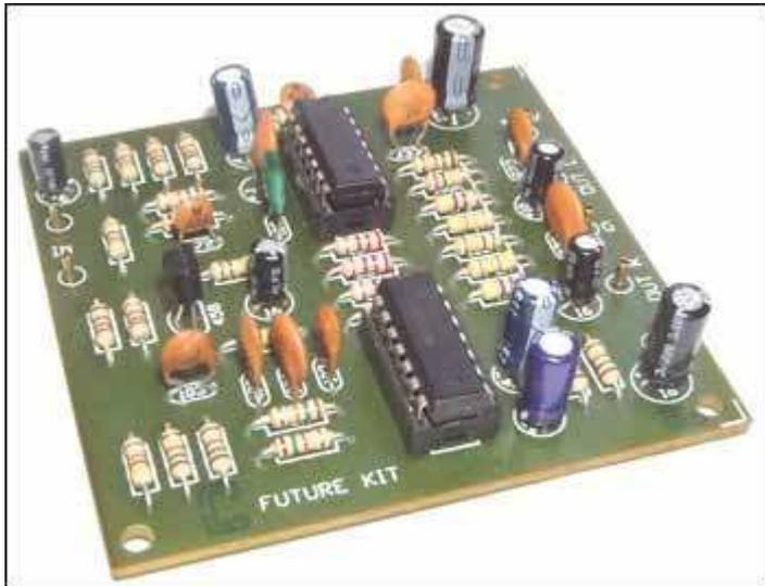
Предлагаемый к сборке набор позволит радиолюбителю собрать устройство, преобразующее монофонический сигнал на входе в псевдостереофонический сигнал на выходе. В результате у слушателя создается впечатление объемности и детальности звука.
