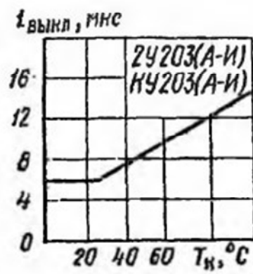
Зависимость времени выключения от температуры корпуса
